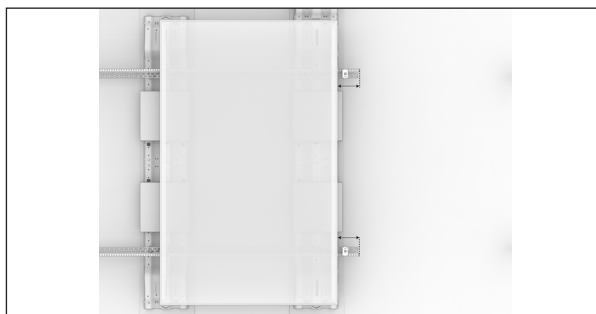
20. Kontrollera att skenans utstick inte överstiger 350 mm från fästets placering.
