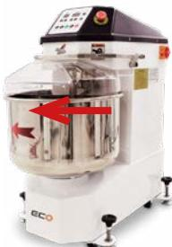
Controleer na het aansluiten op het elektriciteitsnet de draairichting van de kneedspiraal en de kuip. Van bovenuit gezien moet zowel de kneedspiraal als de kuip in wijzerzin draaien. De pijl op de kuip geeft tevens de draairichting aan.
