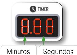
El temporizador para el primer y segundo ciclo se encuentra en la parte superior del panel. El temporizador indica el tiempo de mezcla en minutos y segundos. Se ajusta mediante las teclas  $+$  y  $-$ . Si pulsa la tecla  $+$  el tiempo aumenta. El tiempo máximo que se puede ajustar es de 10 minutos. Pulse la tecla  $-$  para reducir el tiempo definido.
