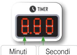
Il timer per il primo e il secondo ciclo si trova sul lato superiore del pannello.
