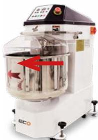
Nach Anschluss der Maschine an die Stromzufuhr überprüfen Sie zunächst die Drehrichtung des Knethakens und der Knetschüssel. Von oben betrachtet sollten sich sowohl der Knethaken als auch die Knetschüssel im Uhrzeigersinn drehen. Der Pfeil auf der Schüssel zeigt die Drehrichtung der Schüssel an.
