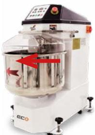
Una vez conectada la máquina a la red eléctrica, compruebe el sentido de giro de la amasadora espiral y de la cubeta. Visto desde arriba, tanto la amasadora espiral como la cubeta deben girar en sentido horario. La flecha en la cubeta indica el sentido de rotación.
