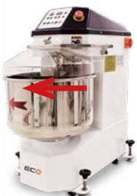
Dopo aver collegato la macchina all'alimentazione elettrica, controllare innanzitutto il senso di rotazione dell'impastatrice a spirale e del recipiente. Visti dall'alto, l'impastatrice a spirale e il recipiente devono ruotare in senso orario. La freccia sul recipiente ne indica la direzione di rotazione.
