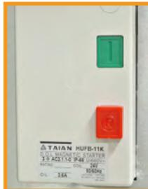
La machine peut être utilisée en pressant le bouton de démarrage ON.
