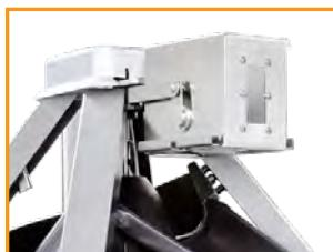
Avant que la pâte atteigne la sortie, elle doit passer sous le farineur. Ce distributeur peut être réglé pour diffuser plus ou moins de farine en adaptant les plaques au dessous.
