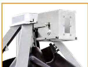
Vooraleer het deeg aan de uitvoer komt, komt het voorbij de bloemstrooier. Die kan ingesteld worden om meer of minder bloem te verdelen door de positie van de platen onderaan. Hierna komt het deeg bij de uitvoer **(C)**.
