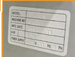
Avant de brancher la machine, il faut contrôler si le voltage qui est indiqué sur la plaque signalétique correspond bien à celui du réseau électrique.
