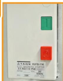
La máquina puede ser operada en apretando el botón de arranque ON. El cono empezará a girar y la masa puede ser metido en la entrada B.
