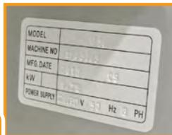
Bitte überprüfen Sie zunächst das Namenschild des Herstellers, damit die erwünschte Stromversorgung die gleiche ist wie diese des Stromnetzes.
