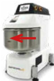
Après avoir branché la machine, vous devez contrôler d'abord la direction de la spirale et de la cuve. Vu du haut, la spirale ainsi que la cuve doivent tourner dans le sens des aiguilles d'une montre. La flèche indique la direction de rotation de la cuve.
