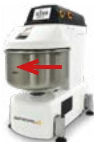
Después de haber conectado la máquina a la alimentación eléctrica, en primer lugar hay que controlar la dirección de rotación de la espiral y de la cuba. Visto de arriba, la espiral como la tina deben girar en el sentido de las agujas del reloj. La flecha en la cuba indica la dirección de girar de la cuba.
