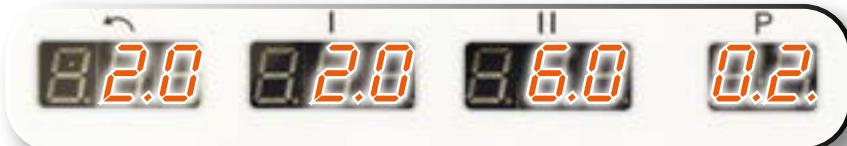
Configura los temporizadores para la dirección inversa, primera y segunda velocidad.
