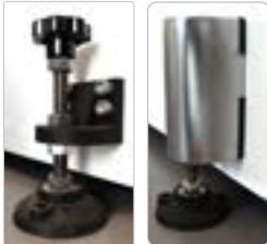
La máquina debe ser instalada en un fondo horizontal y plano. Ponga los tornillos en posición de modo que la máquina está apoyada sólidamente sobre sus cuatro artistas.
