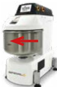
Controleer na het aansluiten op het elektriciteitsnet de draairichting van de kneedspiraal en de kuip. Van bovenuit gezien moet zowel de kneedspiraal als de kuip in wijzerzin draaien. De pijl op de kuip geeft tevens de draairichting aan.
