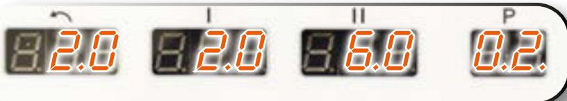
Configura i timer per la modalità inversa, la prima e la seconda velocità.
