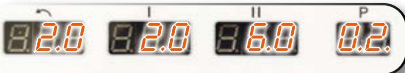
Stellen Sie die Timer für die Rückwärtsrichtung, die erste und zweite Geschwindigkeitsstufe ein.
