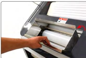
Bij onderhoud en reiniging van de machine dient deze steeds van de stroomtoevoer te worden afgesloten door de stekker uit het stopcontact te halen.
