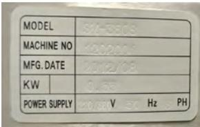
Avant de brancher la machine, il faut contrôler si le voltage de la machine correspond bien à celui du réseau électrique.
