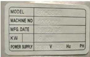
Antes de conectar la máquina, hay que controlar si el voltaje de la máquina corresponde al suministro de electricidad.
