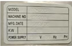
Die Stromversorgung muss der Voltzahl der Maschine entsprechen, wie diese auf dem Namenschild des Herstellers angegeben ist.
