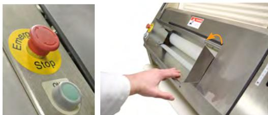
Bij onderhoud en reiniging van de machine dient deze steeds van de stroomtoevoer te worden afgesloten door de stekker uit het stopcontact te halen.
