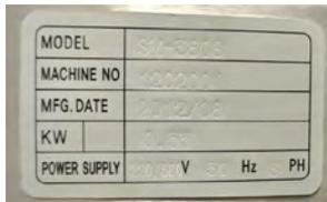
Prima di allacciare la macchina, controllare che il voltaggio della macchina corrisponda alla fornitura d'elettricità.
