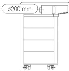
Es wird empfohlen, eine Ablufthaube direkt über dem Ofen zu montieren, um Dampf und Kochdünste aus dem Raum zu entfernen, ein Ø200 Metallbalg wird benötigt, um die Haube mit der Wand- oder Dachöffnung zu verbinden, so kann das Risiko von Korrosion und durch Feuchtigkeit verursachtem Kurzschluss weitgehend reduziert werden.
