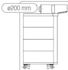
Il est recommandé d'installer une hotte avec un ventilateur d'extraction sur le four pour évacuer les vapeurs et fumées de cuisson. Un tube de 200 de diamètre est nécessaire pour raccorder la hotte à l'évacuation extérieure dans le toit ou le mur. Ceci évitera de la corrosion ou un court-circuit éventuel.
