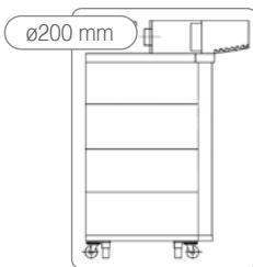
Om de stoom en rook uit de oven af te voeren, raden wij aan een dampkap op de oven te plaatsen. Een flexibele buis met Ø 200 is nodig om de dampkap met de afvoer in het dak of de muur te verbinden. Op die manier kan het risico op corrosie of kortsluiting door vochtinsijpeling tot een minimum beperkt worden.
