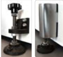
Die Maschine muss auf einen horizontalen und egalen Boden gestellt werden.
