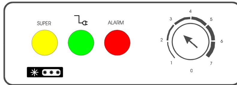
Der Thermostat kann auf eine Skala von 1-7 eingestellt werden, das entspricht ca. -15 bis -25°C. Eine Einstellung auf 3-4 ist in den meisten Fällen das Optimale.
