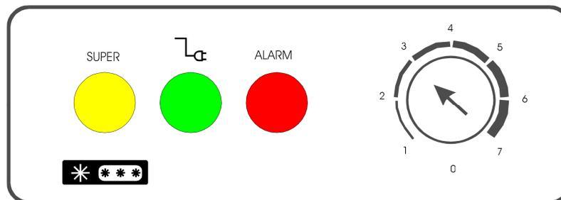
El termostato se puede regular en una escala del 1 al 6, que equivale a entre -15 y -25°C
