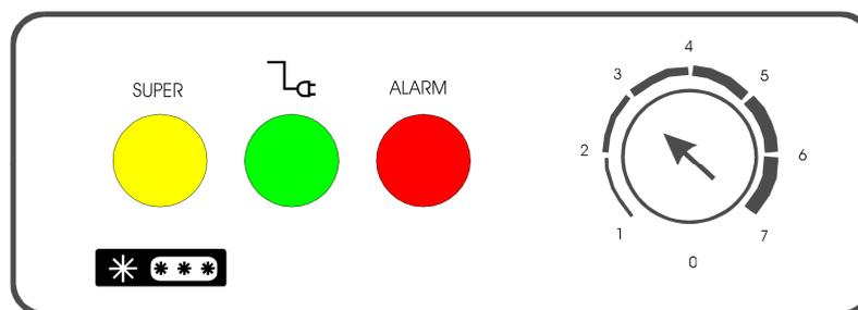
Термостат настраивается по шкале от 1 до 7, что равнозначно температуре от -15 до -25С. Оптимальный настрой является при расположении стрелки на 3 или 4. Система охлаждения отключается при расположении стрелки на 0.
