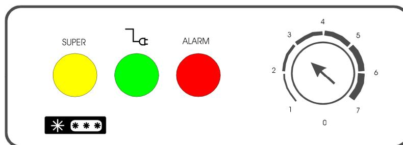
Termostaten kan ställas in på en skala från 1 till 7, vilket motsvarar cirka -12 °C till -25 °C. En inställning på 3–4 är oftast optimal.
