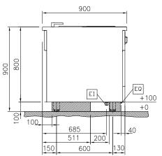
Drain ΕI Electrical inlet (power) EQ WI **Equipotential** screw Water inlet
